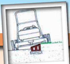
Exemple de pose permettant le passage de la tondeuse à cheval
